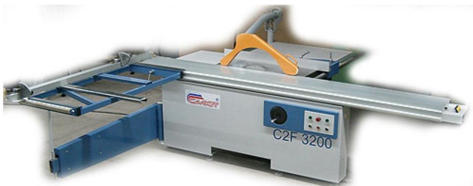
Форматно-раскroечный станок относится к деревообрабатывающему оборудованию и предназначен для форматного раскroя облицованных, древесно-стружечных и древесноволокнистых плит, а также, для продольного и поперечного раскroя пиломатериалов на мебельные, столярные и другие заготовки.
