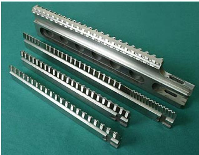
Профильные плоские протяжки изготавливаются из высококачественных быстрорежущих сталей отечественного и импортного производства, в сочетании с однослойными или комплексными покрытиями.
