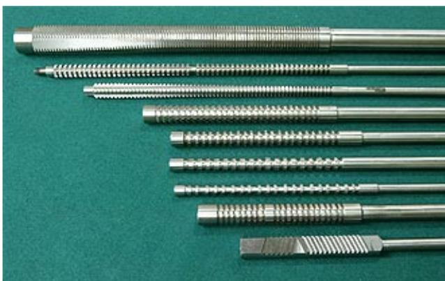
Протяжки круглые (4мм до 100мм), шлицевые ( $m=0,5\text{мм}$  до  $m=5\text{мм}$ ), прошивки изготавливаются из высококачественных быстрорежущих сталей отечественного и импортного производства, в сочетании с однослойными или комплексными покрытиями. Термическая обработка производится в горизонтальной вакуумной печи фирмы SECO WARWICK.
