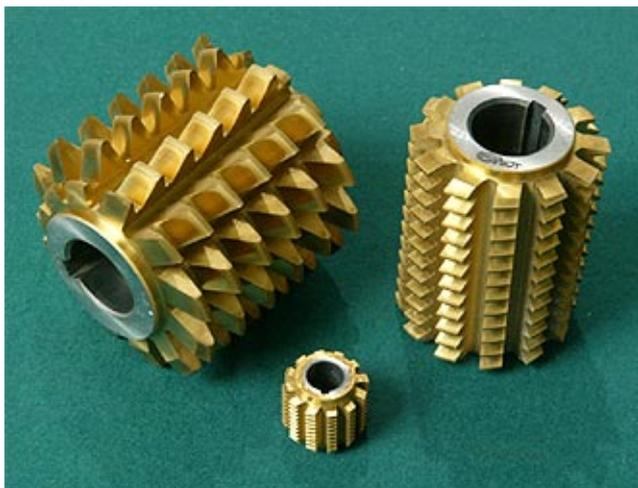
Червячные фрезы изготавливаются на высокоточных станках с ЧПУ фирм REISHAUER AG и ВИЗАС из высококачественных быстрорежущих сталей отечественного и импортного производства, в сочетании с однослойными или комплексными покрытиями.
