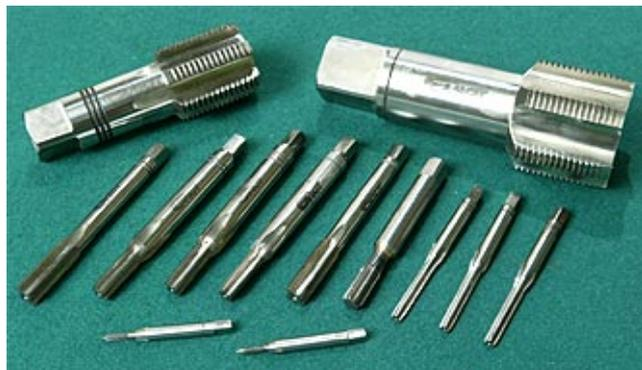
Резьбонарезной инструмент изготавливается из высококачественных быстрорежущих сталей и твёрдых сплавов, отечественного и импортного производства, с однослойными или комплексными покрытиями.
